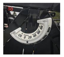
Figure 3-9. Incline Meter
