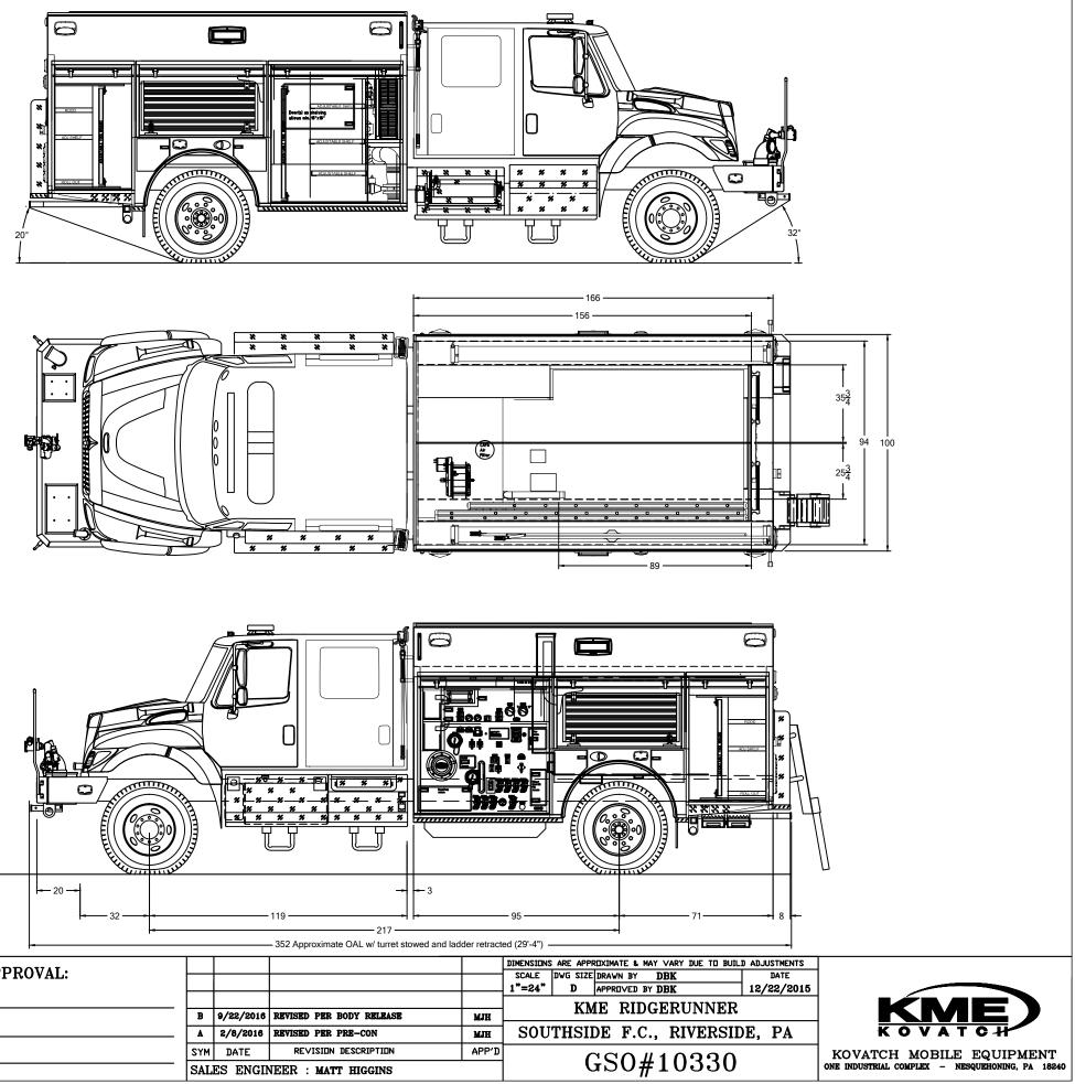
NAVISTAR 7400 4X4 CREW CAB MAXXFORCE 9 330HP DIESEL WATEROUS 1250 CXVPA W/ ONE STEP CAFS 600 GALLON POLY TANK / 30 GALLON FOAM 166" RIDGERUNNER BODY 3/16" ALUMINUM
