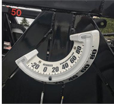
**Figure 3-9. Incline Meter**
